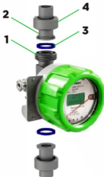
Рисунок 2.8 – Установка ротаметра с муфтовым присоединением к трубопроводу
